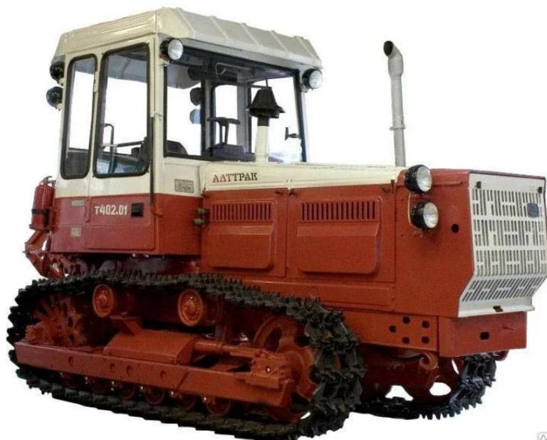
Т-4А.02 почти идентичная копия Т-4А.01. Но есть одно ключевое отличие - он оснащен другим двигателем. Речь о дизельном двигателе КАМАЗ 740.03-135 с такой же мощностью - 130 лошадиных сил. Других отличий не ищите. Трактор Т-4А.02 с камазовским движком предполагалось продавать в тех регионах, где работало много сельхозтехники с двигателями от Камаза. Чтобы проще было обслуживать: там и запчастей можно быстрее найти (навалом в любом магазине) и обслуживающую сервисную организацию.
