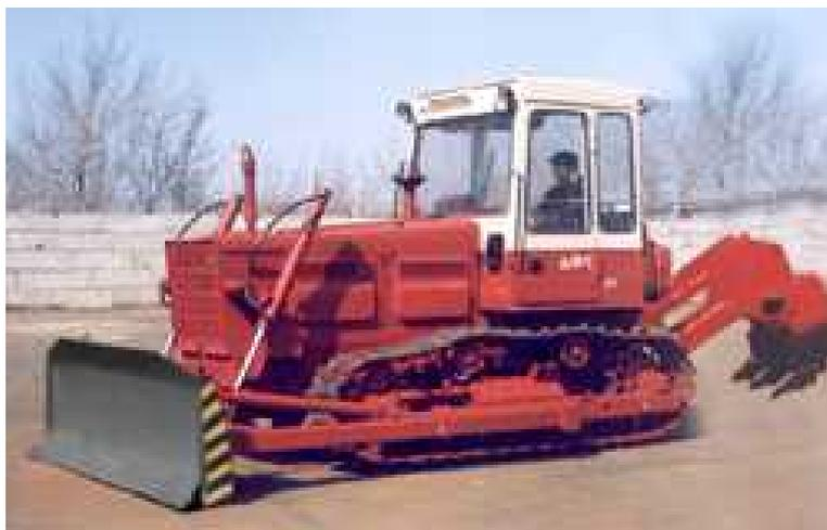
Гусеничный трактор Т-4А2П.01 тягового класса 4 является промышленной модификацией сельскохозяйственного трактора Т-4А.01. Он предназначен для работы в агрегате с дорожно-строительным оборудованием на грунтах 1-2 категорий, а также с прицепными сельскохозяйственными машинами из шлейфа трактора Т-4А.01, не требующими привода от вала отбора мощности. Выпускается в комплектации с бульдозерным оборудованием ОБГН-4М, рыхлителем РН-4, погрузчиком навесным ПН-4.
