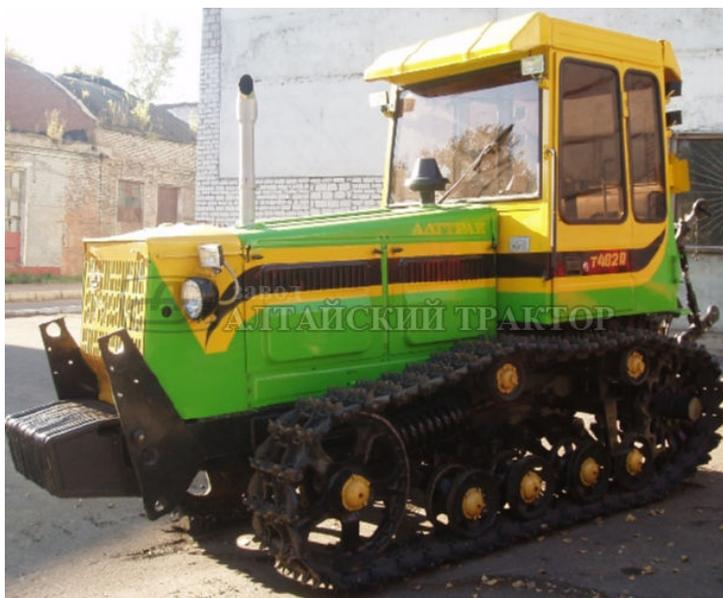
Габаритные размеры трактора (длина – 6720 мм; ширина – 1750 мм; высота – 3200 мм) обеспечивают ему высокую маневренность и проходимость. Обширный перечень осуществляемых гусеничным трактором операций обусловлен многофункциональной конструктивной системой для крепления навесного, полунавесного и прицепного оборудования и механизмов.
