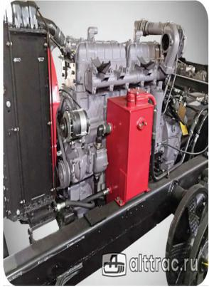
В базовой комплектации на трактор устанавливается **6-ти цилиндровый** 170-сильный двигатель Д-461 с газотурбинным наддувом, снабженный непосредственным **впрыском топлива** и с рядным вертикальным расположением цилиндров. По специальному заказу возможна установка двигателей ЯМЗ-236 мощностью 184 л.с.
