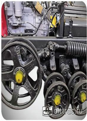
Независимая торсионная подвеска трактора Т-404 обеспечивает наилучшие плавность хода и поддресоривание трактора, позволяет ему работать на больших скоростях, способствует высоким сцепным качествам. В конструкции подвески применен гидравлический механизм натяжения колеса направляющего. Специальная конструкция катков для быстрого очищения от грунта. На тракторе используются гусеницы с прорезиненными пальцами РМШ для увеличения мягкости и плавности хода.
