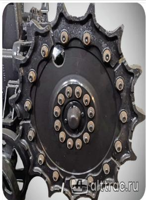
На трактор Т-404 устанавливается колесо ведущее со съемными зубчатыми сегментами зацепления для увеличения экономичности и простоты технического обслуживания трактора.
