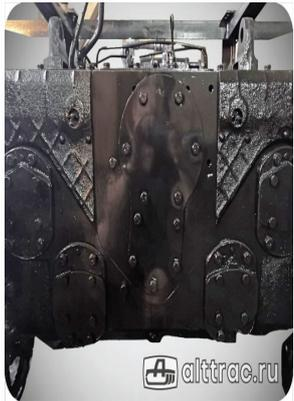
Усиленная трансмиссия силовой передачи с чугунным корпусом моста для надежной и долговечной работы в условиях повышенных температур.
