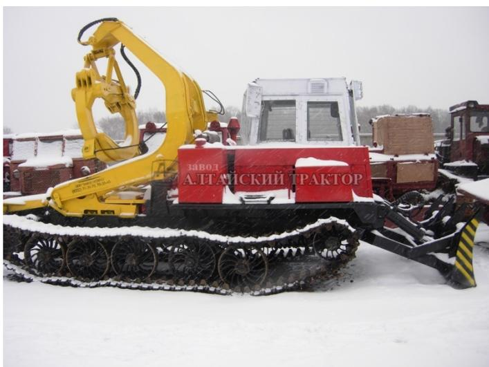
Машина применяется для подбора и формирования пачек стволов объемом до 10 м.куб. при максимальной площади захвата 1,8 м.кв., перемещения груза, штабелирования и погрузочных работ на автомобильный и железнодорожный транспорт. Максимальный уклон рабочей площадки не должен превышать 15°.
