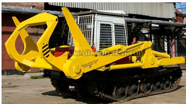
Перенос груза осуществляется над кабиной оператора, вдоль центральной оси транспортного средства. Максимальная грузоподъемность – 4 тонны. Максимальная высота подъема при переносе – 4 м.
