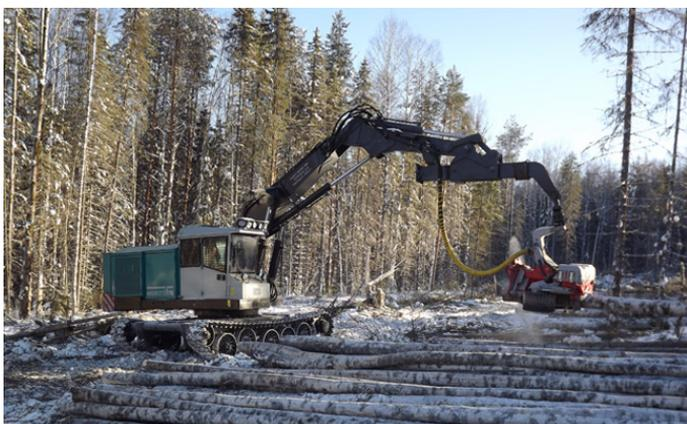
Широкая гусеничная база в комплектации с мощными силовыми дизельными установками позволяет проводить технологические операции в местностях со сложными геологическими и климатическими условиями, в том числе и на заболоченных и подтопленных почвах.
