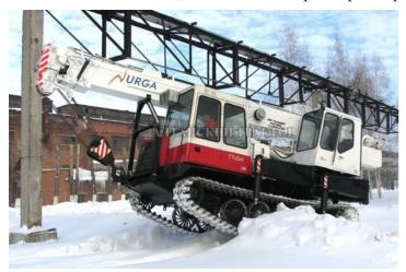
Максимальная грузоподъемность ограничена 25 тоннами при минимальном вылете трехсекционной стрелы. Наибольшая высота подъема — 20,5 м. В комплектации может присутствовать стандартная удлинительная секция, при установке которой высота подъема груза достигает 27,4 м.
