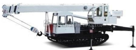
Гусеничный кран КС-4671 снабжен индивидуальной кабиной оператора с увеличенным обзором, системой безопасности, двухконтурной системой гидрофикации. Управление осуществляется с помощью гидравлической системы с двумя джостиками. Кран КС-4671 может быть оборудован дополнительным оборудованием, позволяющим расширить список выполняемых задач.
