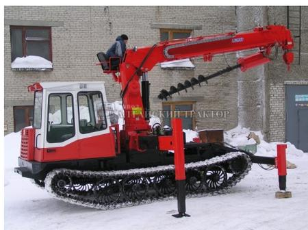
При максимальной длине стрелы вес превышает 270 кг. Высота подъема монтажной люльки – 23 м. Гидравлический тип привода исполнительных механизмов. Комплектуется 4 аутригерами.
