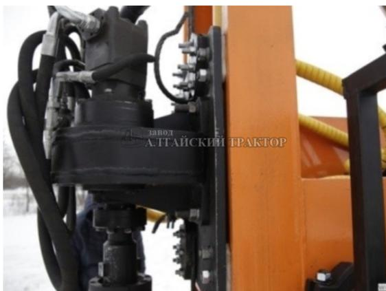
Установка роторного бурения УРБ 2А2 на шасси трелевочного трактора ТТ-4М используется для сверления разведочных геофизических скважин в геологоразведочных партиях. Использование метода промывки раствором или продувки шурфа позволяет проводить бурильные работы на глубину до 300 м. Для бурения используется роторное (вращающееся) долото или шнековое оборудование.
