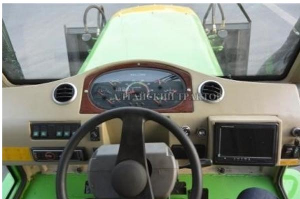
Наличие интегрированной системы видео-обзора дополнительно облегчает условия труда оператора. Бульдозер имеет комфортабельную кабину оператора, кондиционер, подрессоренное кресло, аудиосистему, эргономичную компоновку органов управления и приборов, а также превосходную шумоизоляцию
